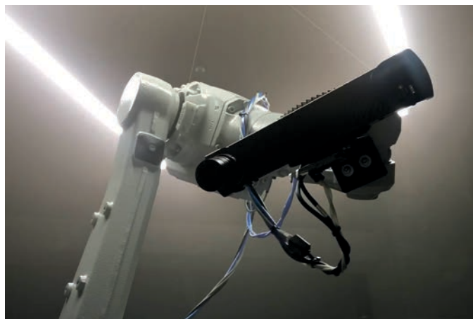
Un esempio di telecamera 3D, in questo caso MotionCam 3D distribuita da Advanced Technologies, applicata su un robot
